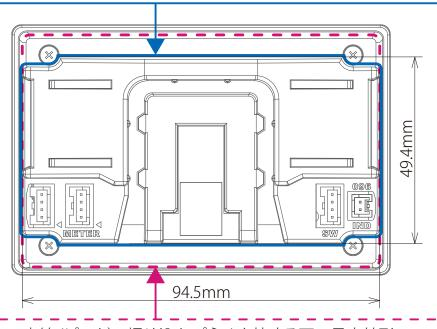
点線(ピンク): 埋め込むパネルと接する面の最大外形
